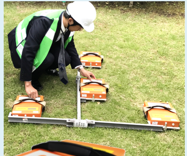
微動探査システム 「地震eye™」 微動探査は振動から地盤の特性を推測する調査法です。SWS試験と微動探査とを併用することで、より詳しく調査地の地盤特性がわかります。
