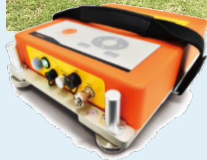
微動探査システム 「地震eye™」 微動探査は振動から地盤の特性を推測する調査法です。SWS試験と微動探査とを併用することで、より詳しく調査地の地盤特性がわかります。
